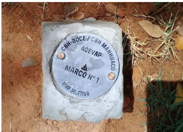
Figura 8 – Exemplo de marco topográfico
